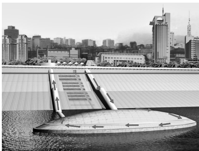
图 24 涪陵白鹤梁题刻原址水下保护工程方案示意图
