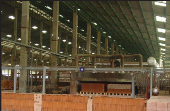
เรียงอิฐในโรงงาน แล้วเลื่อนตามาคลุ่ม (Shuttle Kiln) ใช้แกลบเป็นเชื้อเพลิง
