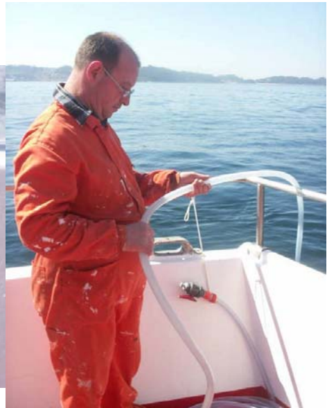
Operación de largado de la manguera con las llaves de paso en posición de abierto (Paso 1).
