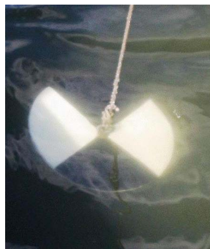
Fig. 1. Distintos modelos y partes de un disco de Secchi y aspecto de un disco sumergido en aguas con abundantes pigmentos verdosos.
