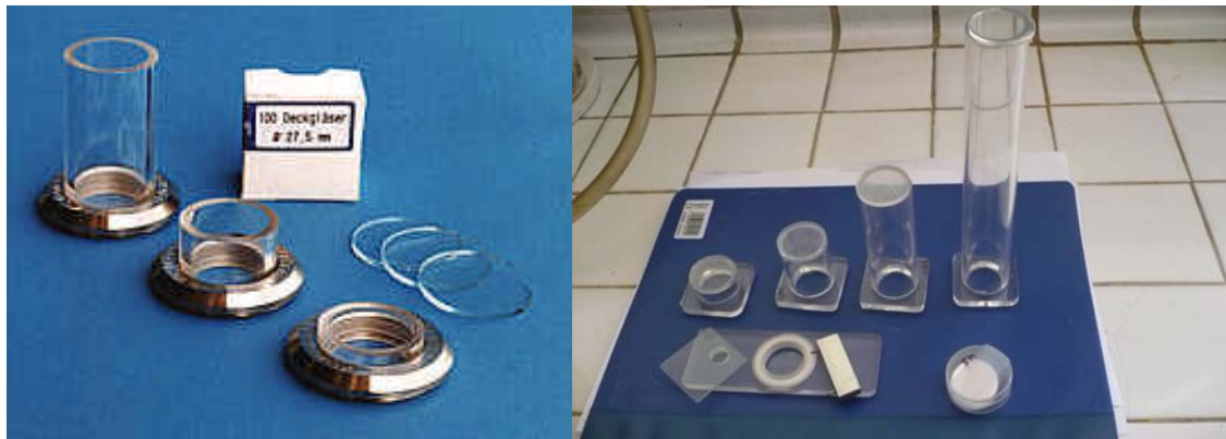
Fig. 1. Izda., cámaras de sedimentación simples de 25, 10 y 5 mL; dcha. cámaras de sedimentación compuestas: columnas de 10, 25, 50 y 100 mL y placa de sedimentación con el cubre cuadrado (izda.) y llave (dcha.) para desenroscar el anillo metálico.
