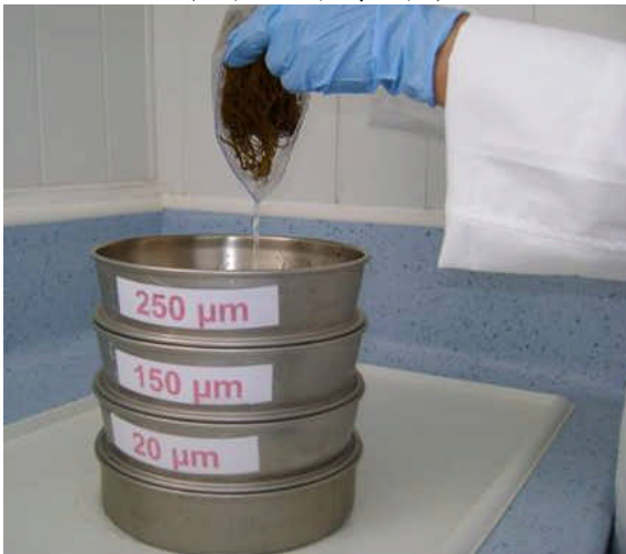
Lavar el residuo contenido en el tamiz de 20 \mu\text{m} con agua de mar filtrada
