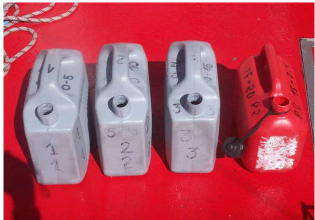
Recipientes de plástico con rangos de profundidad marcados (0-5, 5-10, 10-15, 15-20) para verter el contenido de los distintos tramos de la manguera.
