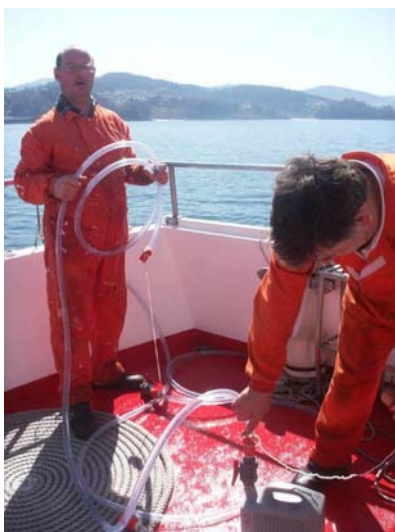
Vaciado de un tramo de manguera en el recipiente que le corresponde, tras abrir la llave de paso.
