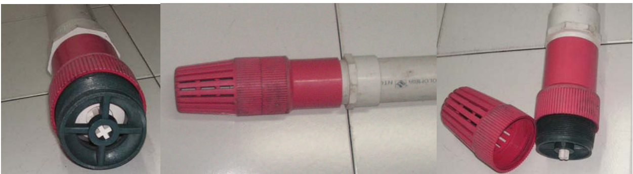
Fig. 6. Detalles de la válvula check de piso utilizada en los muestreos con el tubo de 2 pulgadas de diámetro (Foto INVEMAR, Colombia)
