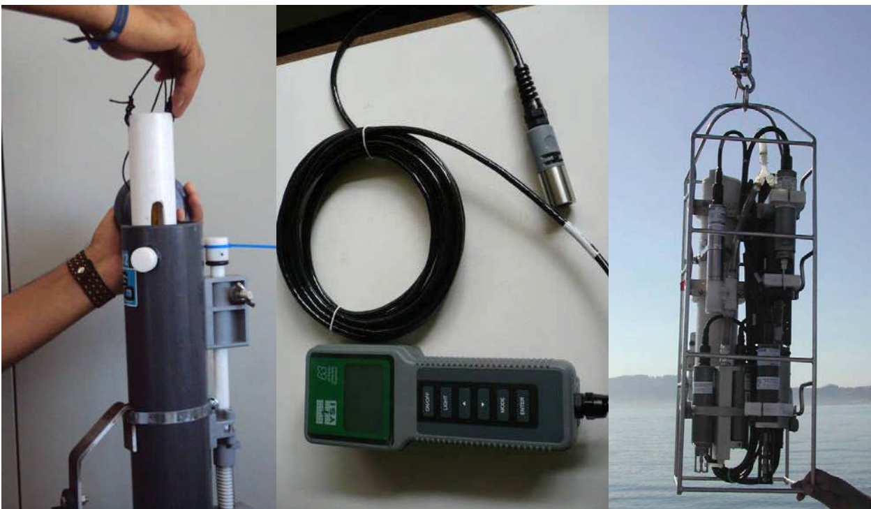
Fig. 1. Izda., uso de termómetro de inmersión introduciéndolo directamente en la botella oceanográfica; Centro, sonda multiparamétrica YSI para medir temperatura y salinidad; Dcha. Sonda multiparamétrica CTD ( C onductivity, T emperature, D ept) colgada del torno del barco antes de ser lanzada.
