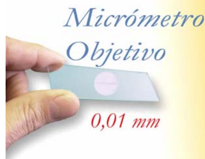
Fig. 4. Arriba, micrométrico ocular, situado encima de una cadena de Cochlodinium sp., para medir los especímenes observados al microscopio. Centro y abajo, micrométrico objetivo tal como se ve desde el ocular y en la mano.
