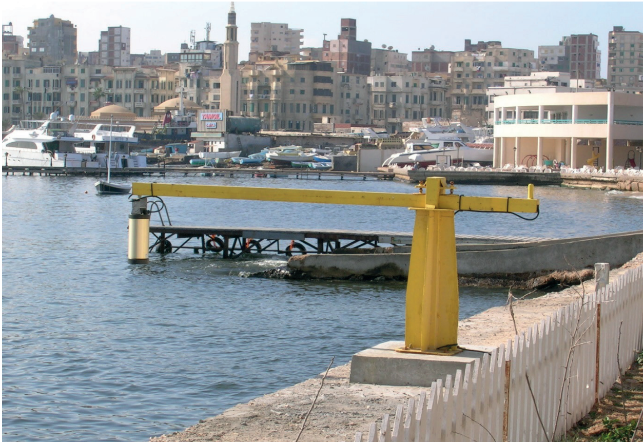
Figure 4.3 Un marégraphe OTT Kalesto à Alexandrie à l'extrémité d'un bras coulissant qui est fixé par des boulons. (Photo T. Aarup, COI).
