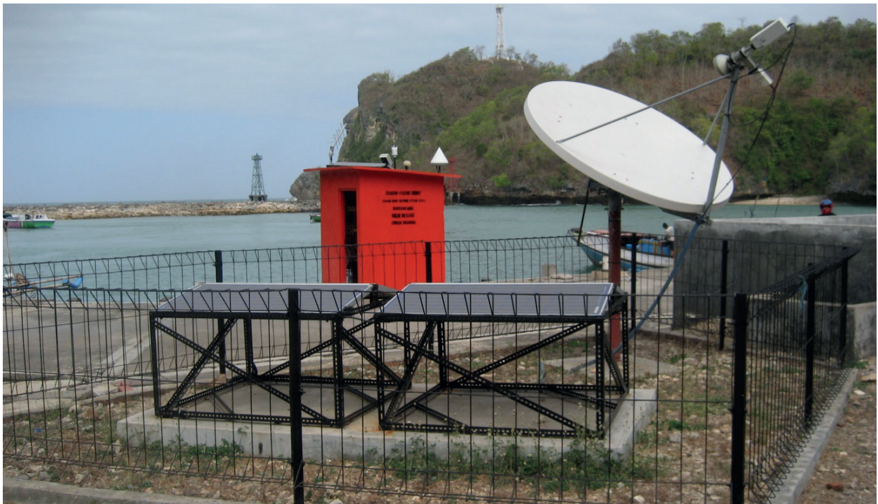
Figure 7.5 Une antenne VSAT à côté d'un marégraphe en Indonésie. Cette station est également équipée d'un marégraphe radar OTT Kalesto et d'un récepteur GPS. (Photo Tilo Schöne, GFZ).
