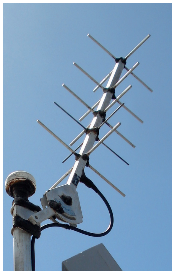
Figure 7.8 Une Antenne Yagi GOES. Le petit hémisphère au sommet du poteau de support est une antenne GPS destinée à la datation des mesures. (Photo NOC.)
