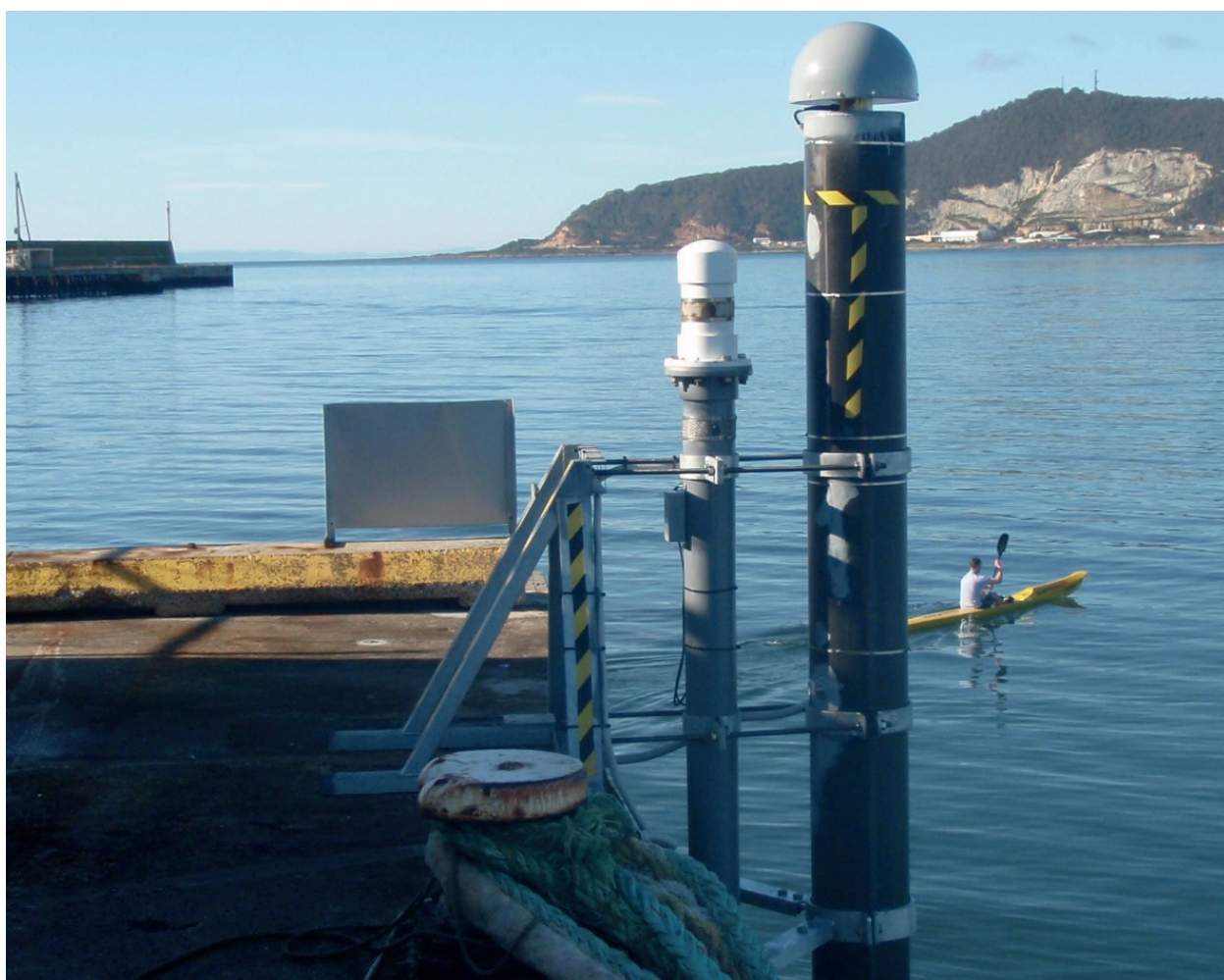
Figure 6.4 Un marégraphe acoustique à Burnie au nord de la Tasmanie en Australie, et à droite, un pilier spécial surmonté d'une antenne GNSS. Photo de Geoscience Australia. Tiré de Pugh et Woodworth (2014).
