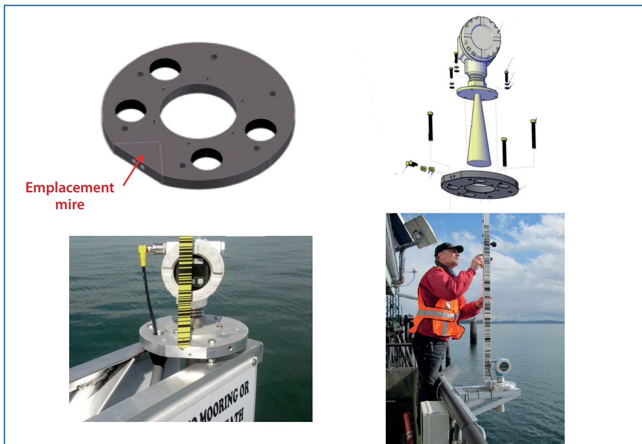
Figure 4.4 Collet de montage utilisé par la NOAA pour les marégraphes radar à cornet tels que le Waterlog H-3611. Le collet qui est un disque en aluminium de 2,54 cm d'épaisseur avec des trous de fixation pour le capteur et son arrimage au support. Une mire de nivellement peut être placée sur la partie plate de la face avant du collet pour permettre une connexion géodésique aux repères voisins. (Photos NOAA).
