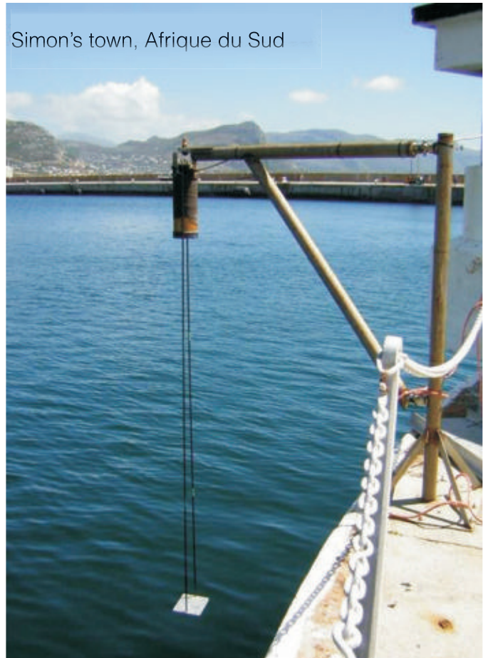
Figure 4.12 Exemples de l'utilisation de la cible « en étrier » à Luderitz en Namibie et Simon's Town en Afrique du Sud. (Photos Ruth Farre, Service hydrographique de la marine sud-africaine).
