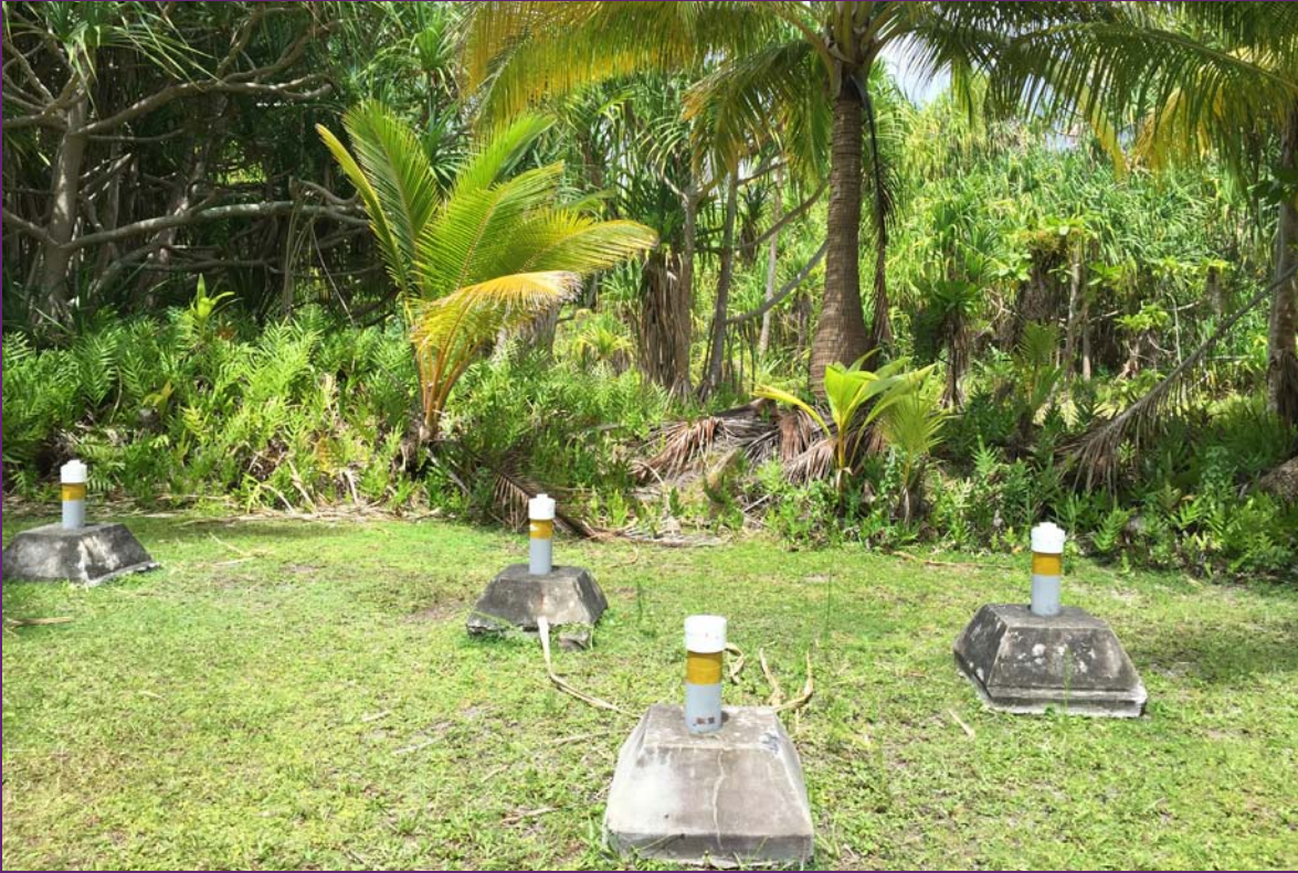
Puits de surveillance des eaux souterraines sur l'île de Roi-Namur, dans l'atoll de Kwajalein (République des Îles Marshall)
