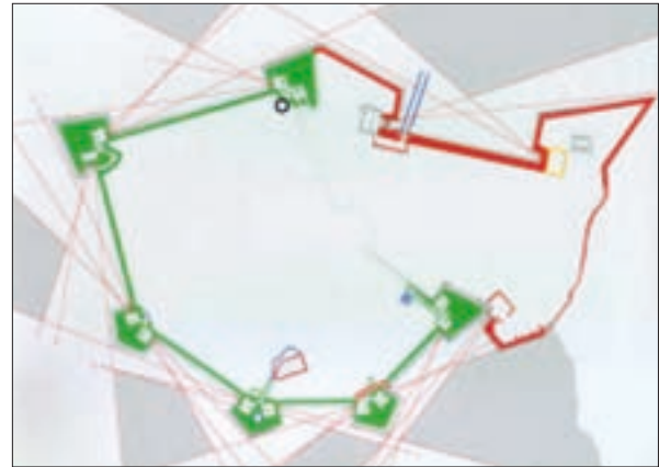
Estudio de traza y etapas constructivas de la muralla a partir de la apertura de los fuegos de flanco.
