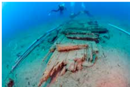
Descoberto durante a fase final das dragagens, BH-006 corresponde a um navio construído com algumas madeiras americanas, pregado e chapeado com ligas de cobre, com técnicas comuns ao século XIX.
