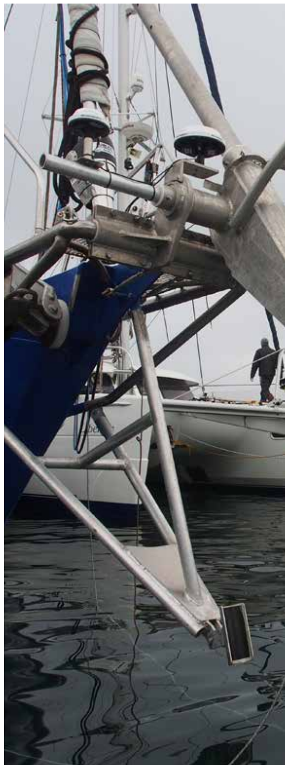
Sonar multifaisceaux à haute résolution, monté sur le voilier « Explorer of Sweden », lors de l'expédition VEGA 2013, dans la mer du Groenland.
