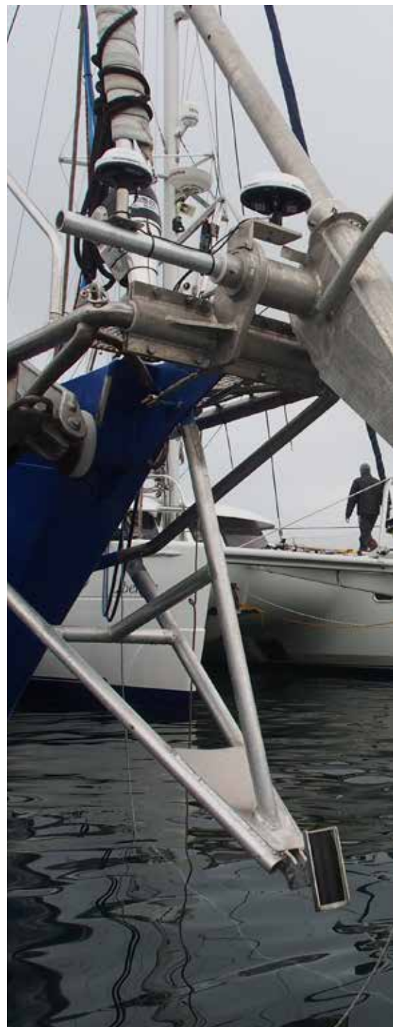
Эхолот с высоким многолучевым разрешением установлен на паруснике «Explorer» во время экспедиции ВЕГА 2013, в Гренландском море.
