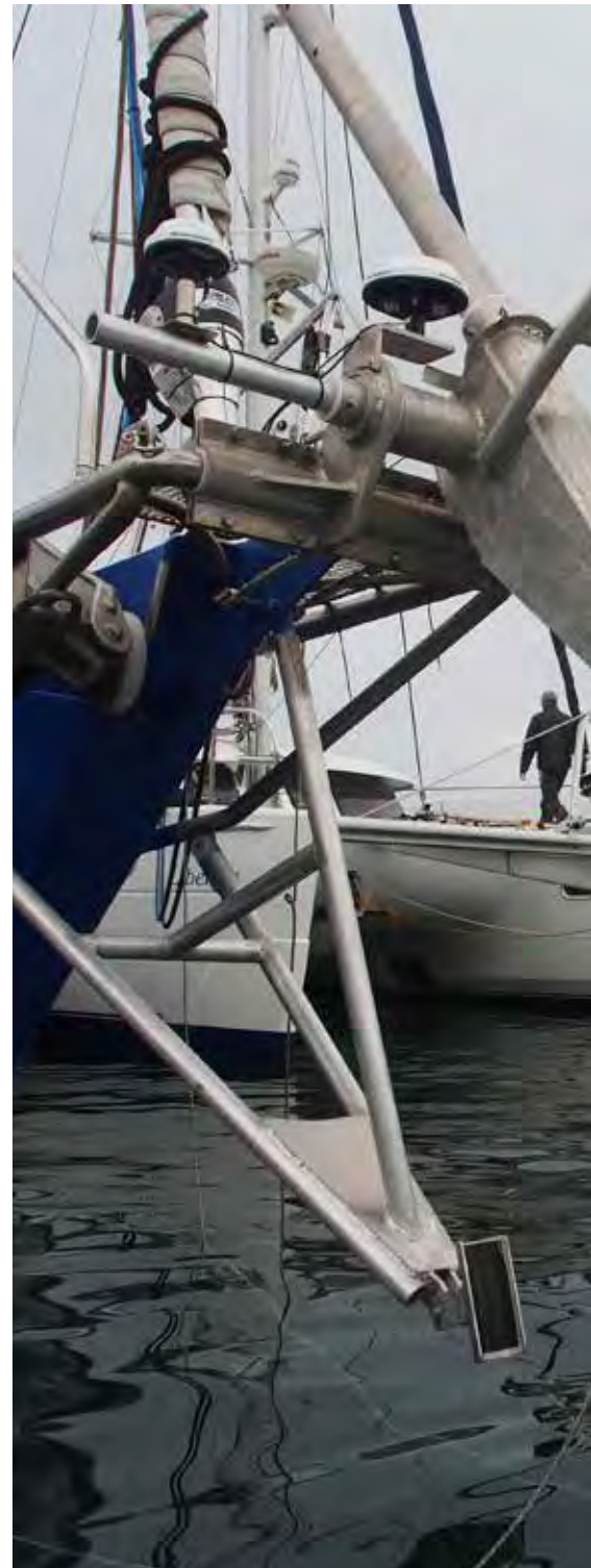
Sonar multihaz de alta resolución, instalado en el velero "Explorer of Sweden", durante la expedición VEGA 2013 en el mar de Groenlandia.
