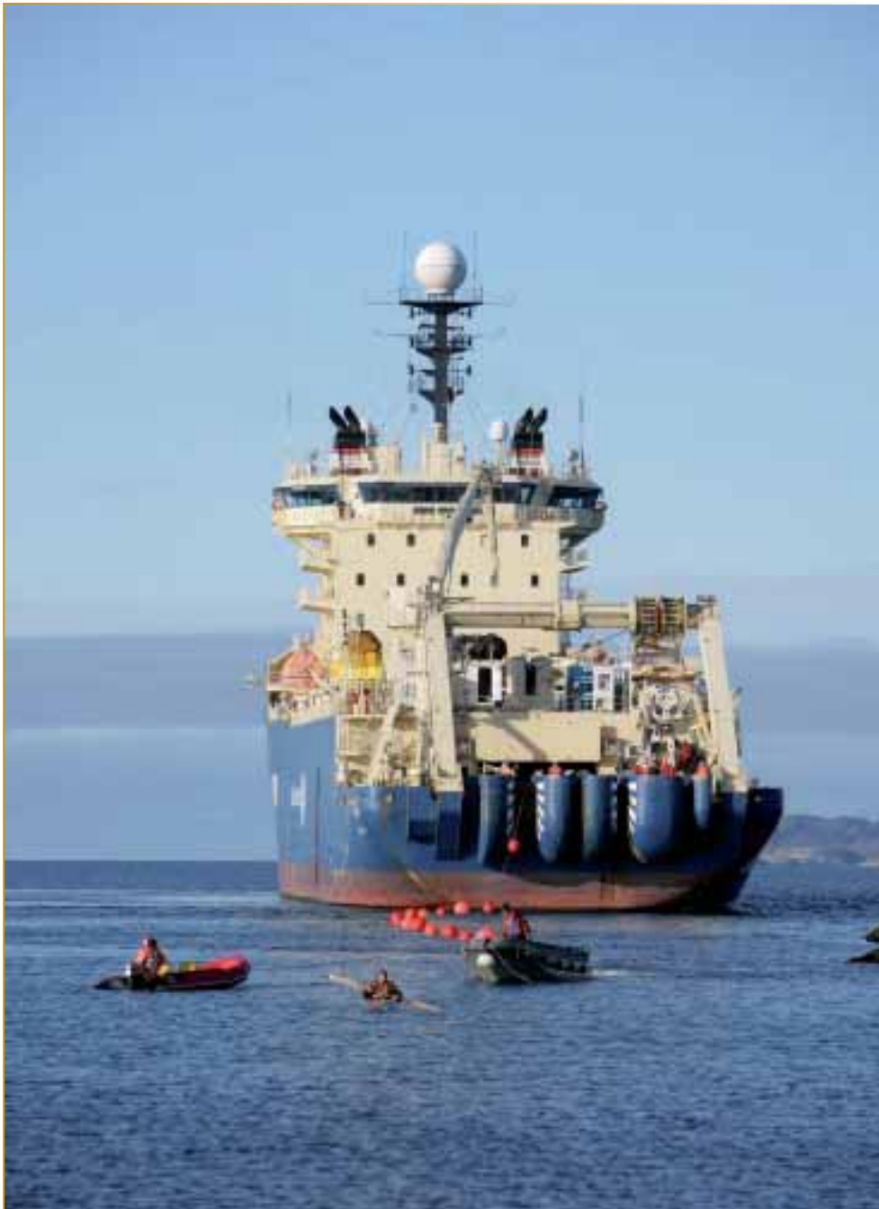
À Nuuk, le rameur d'un kayak hisse à terre le câble optique sous-marin reliant le Groenland à l'Islande puis l'Europe, ainsi qu'au Canada et à l'Amérique du Nord. Ce câble de Tele Greenland Ltd. porte le nom de « Greenland Connect » (photo : Jørgen Chemnitz/ Tele Greenland Ltd.).
