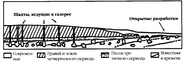
Рис. 59. Схематический разрез кремнедобывающего района Спиеинн, Хэно, Бельгия (по Clark, 1955)
