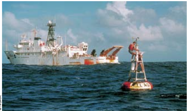
L'une des 70 bouées amarrées dans le Pacifique tropical, qui surveillent et aident à prévoir les apparitions d'El Niño dans le cadre du système mondial d'observation de l'océan. Le dernier épisode d'El Niño a eu lieu en 2002-2003
