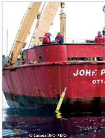
© Canada DFO-MPO Un profileur Argo est largué à bord du navire des garde-côtes canadiens John P. Tully dans le golfe de l'Alaska
