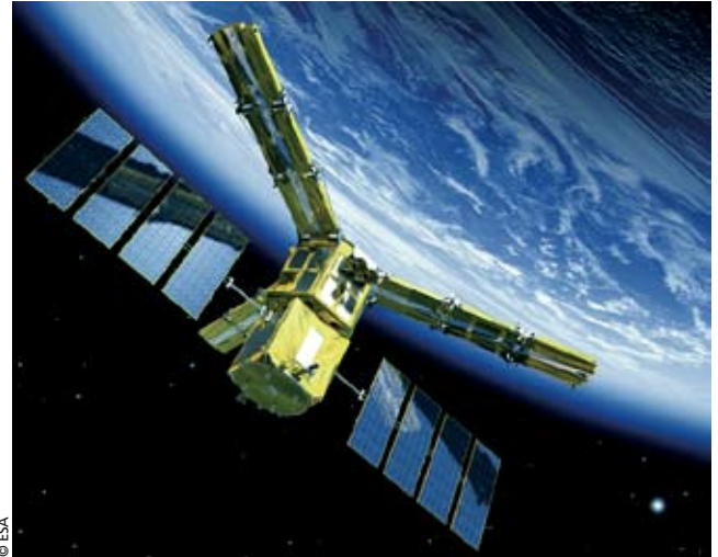
Les satellites assurent une couverture mondiale des océans et constituent un élément clé du GOOS. Voici une vision d'artiste du satellite européen SMOS qui va mesurer la salinité de surface à partir de 2007
