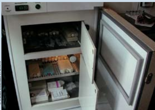
Réfrigérateur solaire utilisé pour la conservation des médicaments dans les centres de santé des zones rurales et isolées. Cette technologie était l'un des thèmes de l'école solaire de cette année
