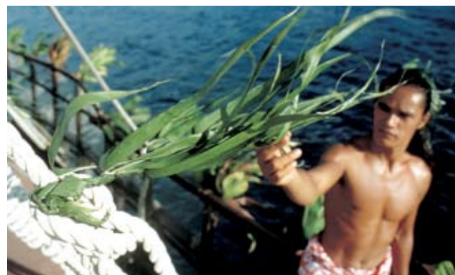
La navigation traditionnelle dans le Pacifique ; le feuillage accroché au gréement est un moyen simple de suivre les moindres modifications de la direction et de la force du vent
