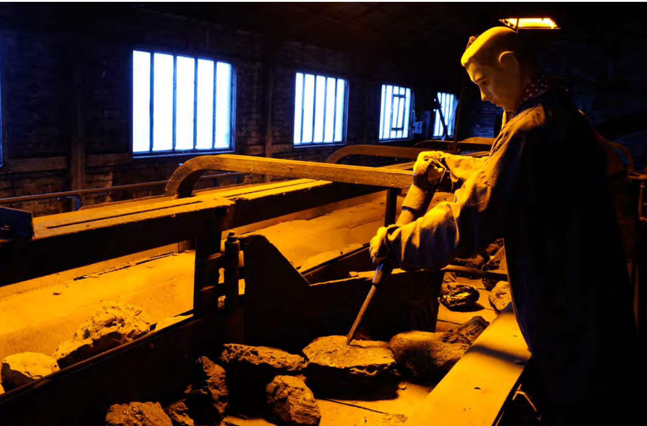
n° 20 - Les blocs trop gros sont fragmentés au marteau piqueur
