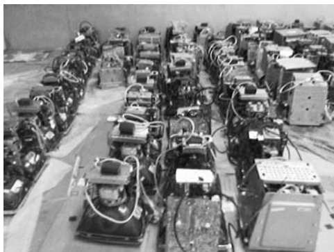
Figura 7: Desmontaje de los televisores
