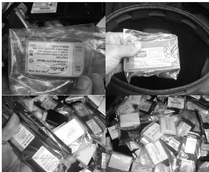
Figura 13 a-d: Tratamiento de baterías usadas. Luego de su verificación son acondicionadas en bolsas y en tambores.
