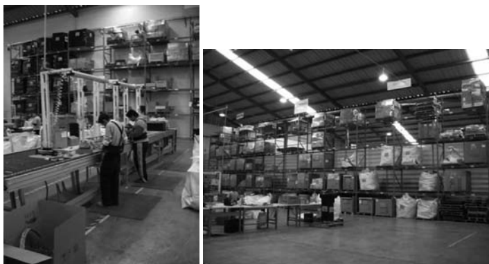
Figura 3a y 3b: Operaciones seguras y profesionales de desmontaje, separación y acopio de los materiales recuperados de los RAEE, como cables, metales, plásticos, etc.
