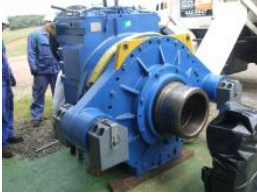
Figura #20. Caja de transmisión multiplicadora para una turbina eólica
