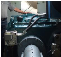
Figura #21. Sección exterior del pistón hidráulico de control del ángulo de paso de las aspas
