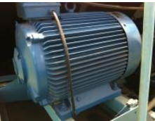
Figura #2. Motor de inducción utilizado como generador
