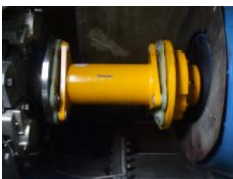
Figura #19. Barra de reacción para la conexión mecánica de la caja de transmisión al eje del generador
