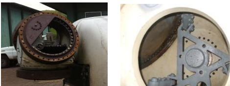
Figura #14. Interior y exterior del cubo que soporta las aspas
