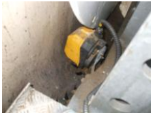
Figura #9. Sensor de movimiento angular de la guiñada
