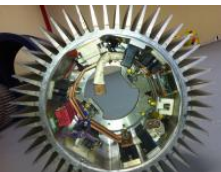
Figura #4. Módulo de control de arranque suave del motor. .generador
