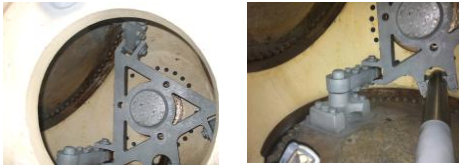
Figura #15. Brazos de la biela que controla el ángulo de las aspas
