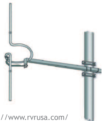
[60] Antena polarizada verticalmente. Cortesía de http://www.rvrusa.com/
