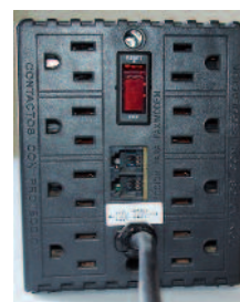
[21]: Regulador con salidas de 110 V y 220 V
