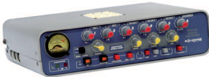
[173] CODEC-Mixer MB2400 de Solidyne. Consola portátil para transmisiones de exteriores de alta calidad Audio over IP
