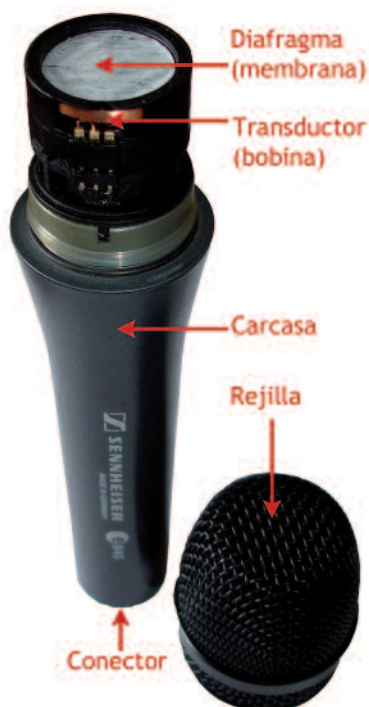
[117] Partes de un micrófono tipo dinámico modelo Sennheiser e845.
