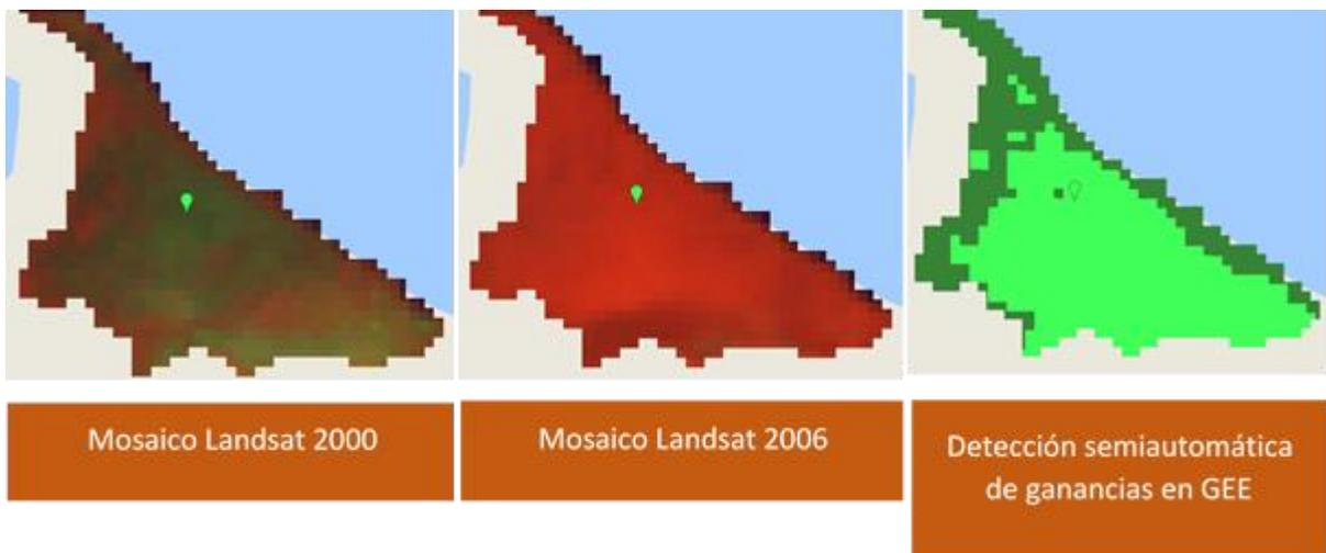
Figura 6. Ejemplo de detección de Ganancia realizada en GEE
