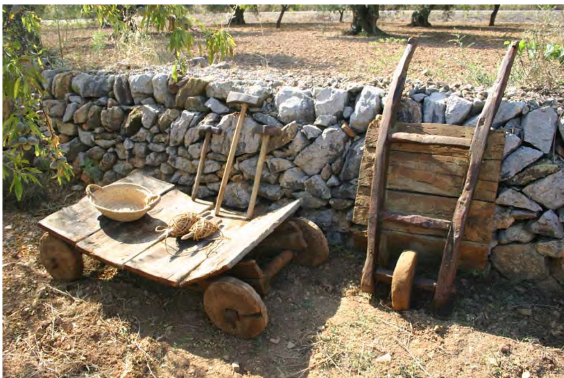
Ferramentes d'arreglar pedra o paredar procedents del mas de la Penya: cabàs, martells, mall, cordells, carretó de quatre rodes i carret de mà.
