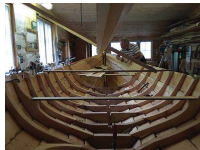
När bordläggningen är klar sätter man spanten på plats för att förstärka och garantera skrovet form.
