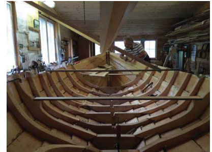
När bordläggningen är klar sätter man spanten på plats för att förstärka och garantera skrovets form.
