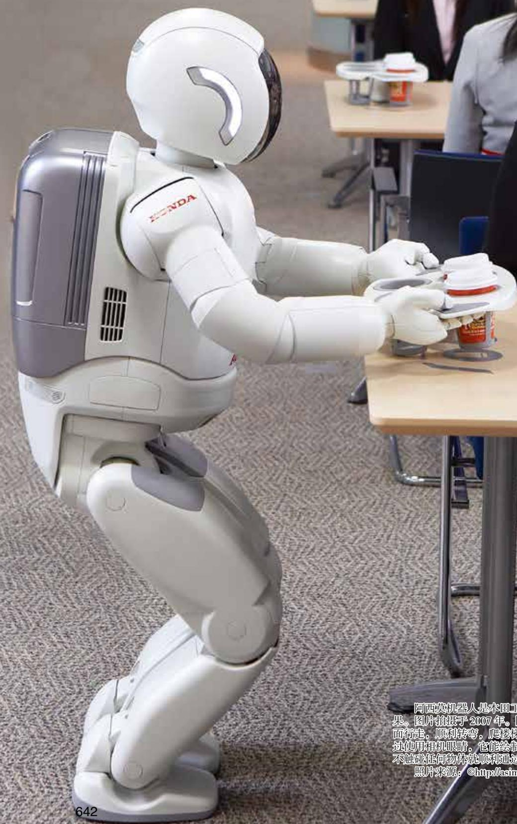
阿西莫机器人是本田工程师近二十年来人形机器人研究的巅峰成果。图片拍摄于2007年。阿西莫机器人能跑，在凹凸不平的山坡和表面行走，顺利转弯，爬楼梯，抓取物体。它能从人群中辨识人脸。通过使用相机眼睛，它能绘制所处环境的地图，记住静止物体。它还能不触碰任何物体就顺利通过一片区域。
