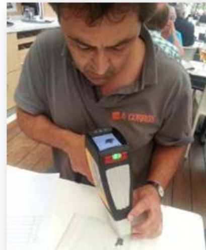
Analyse de l'échantillon du lingot de Sainte-Marie avec XRF © U. Guerin/ UNESCO
