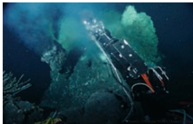
Un véhicule téléguidé de la NOAA en position d'échantillonner ce fumeur noir. Dénommé ROPOS, il descend d'un navire jusqu'au fond de l'océan le long d'un câble de fibre optique. ROPOS est équipé de deux bras manipulateurs, de caméras vidéo et de projecteurs
