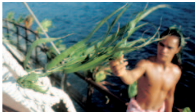
La navigation traditionnelle dans le Pacifique ; le feuillage accroché au gréement est un moyen simple de suivre les moindres modifications de la direction et de la force du vent
