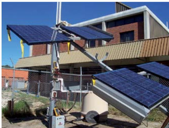
Изготовленный прототип гибридной энергетической минисистемы, где наряду с обычным дизельным генератором используются солнечный и ветряной генераторы и микрогидрогенератор. Она будет обеспечивать общины Индонезии энергией и чистой водой
