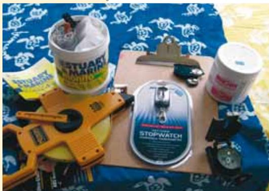
*Equipamentos (da esquerda para a direita em sentido horário): fita métrica, kit de medição da qualidade da água, prancheta, lupa, tabletes de tintura, bússola, cronômetro.*
