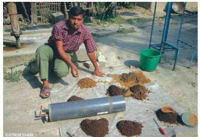
Inspection d'un filtre familial après une année d'utilisation continue. Le sable enrobé d'oxyde de fer prend une coloration brun foncé lorsqu'il est usé. L'oxyde de fer est connu également sous le nom de rouille
