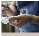
L'atelier de moulage-reparage à la Manufacture de Sévres est chargé de fabriquer depuis le XVIII<sup>e</sup> siècle, les Biscuits de Sévres. Sa fabrication est réalisée en plusieurs étapes : le moulage par estampage puis le reparage (parer de nouveau) qui consiste à remodeler les surfaces.
