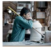
Le tournage métier, hérité du XVIII<sup>e</sup> siècle, est exercé sur le tour en rotation en 2 étapes successives, uniques à la manufacture de Sévres suivant le dessin d'exécution réalisé par le dessinateur d'épur : l'ébauchage et le tournassage.
