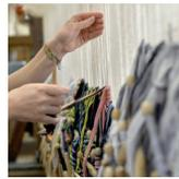
Le lissier réalise son ouvrage sur un métier à tisser spécifique à partir d'un modèle appelé carton, dessin inversé de l'étude. Il procède à différentes étapes : ourdissage, montage de la chaîne. La broche ou filée qui porte le fil de trame recouvre en se croisant les fils de chaîne. A chaque passage, le lissier tasse la trame avec un peigne.
