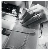
Le piqueur effectue des opérations de préparation et d'assemblage à la machine des pièces de cuir avant leur montage par l'artisan de la table. Il maîtrise l'ensemble des techniques d'assemblage ainsi que les différents types de piqûre et assure les réglages et premières opérations de maintenance de ses machines. Dedité, rigueur et sens de la précision et du détail sont les principales qualités nécessaires pour réussir à ce poste.
