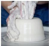
Avec la terre cuite, la faïence, le grès ou la porcelaine, le céramiste transforme la pâte molle et crue en objet dur et inaltérable. Il prépare les terres et les travaille par modelage, tournage ou moulage. Il surveille aussi le séchage et réalise la cuisson et les décors, de la patine aux émaux.
