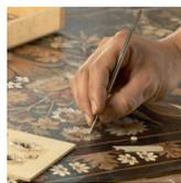
Le restaurateur de meubles procède à un ou plusieurs types d'interventions : nettoyage et traitement du bois, rebouchage des lacunes par masticage ou ajout de pièces, coloration des parties détériorées, aplatissement d'une surface enfoncée, application de cires ou de vernis.
