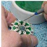
L'émailleur sur métal applique la poudre d'émail sur une surface métallique à l'aide d'une spatule, d'un tamis ou par trempage avant d'effectuer la cuisson. La matière vitreuse, rendue solide lorsqu'elle est chauffée, donne brillant, couleur et solidité au revêtement.
