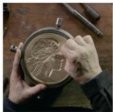
À l'aide d'un burin et d'un ciselet ou d'un laser, le graveur métallier réalise une matrice qui servira à estamper un flan en métal. La gravure s'effectue en creux et à l'envers. Après la frappe, la médaille est détournée, polie et patinée ou traitée par électrolyse.
