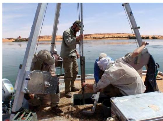
**Photo 11 : Les chercheurs prélèvent des carottes sédimentaires au lac Yoan sur la plateforme.**
