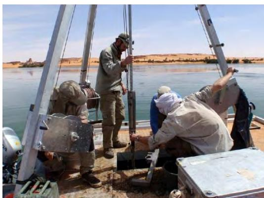
Photo 8 : Les chercheurs prélèvent des carottes sédimentaires au lac Yoan sur la plateforme.
