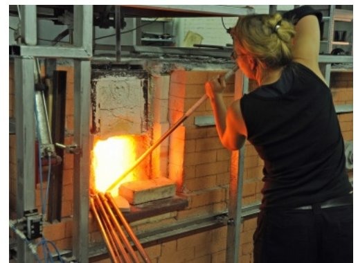
Sara Hulkkonen ottaa lasia uunista pillin päähän. Nuutajärven lasikomppania 2011. Kuva: Suomen lasimuseo / Marja-Leena Salo / TAKO-projekti
