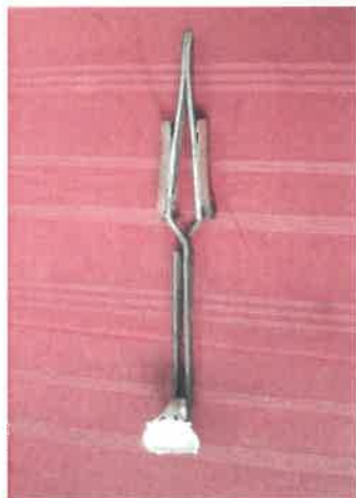
L'emploi des ciselets: pince pour bague
